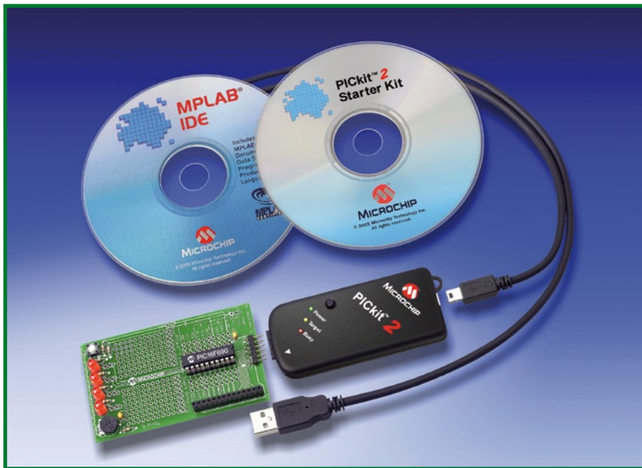
Figuur 2. PICkit 2 is een 'kit-in-een-kit' met uitgebreide mogelijkheden voor alle PIC-gebruikers, want er zit zowel een debugger als een programmer in.
